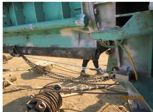
아웃트리거 유압 실린더 및 권과방지장치 상태 점검 - 상태 양호
