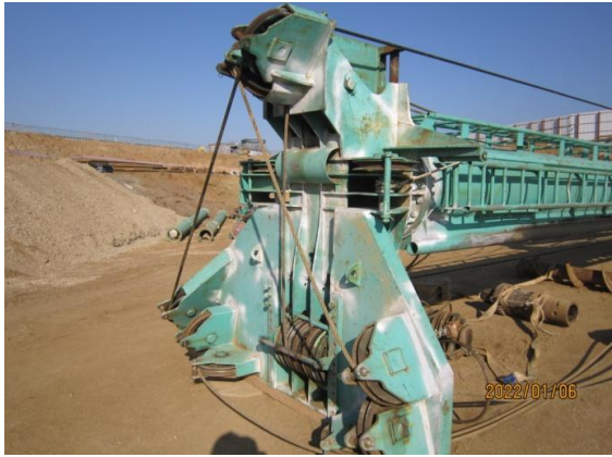
탐시브 육안 및 와이어 시브 상태 점검 - 상태 양호
