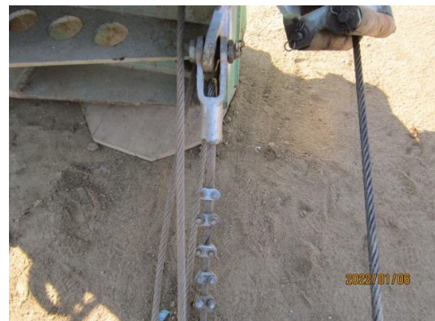
트랙 및 와이어로프 클립체결 상태 점검 - 상태 양호
