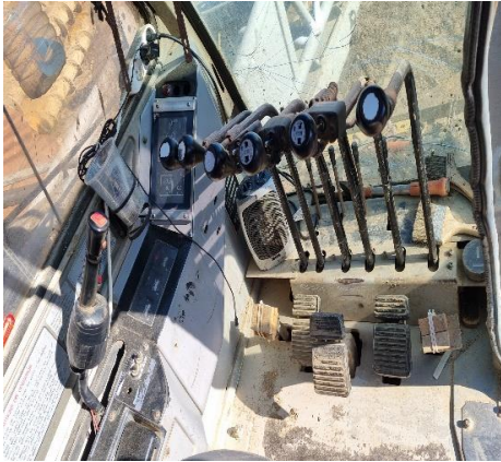
- 운전실 조작 레버 및 인디게이터 과부하장치 점검 상태양호
