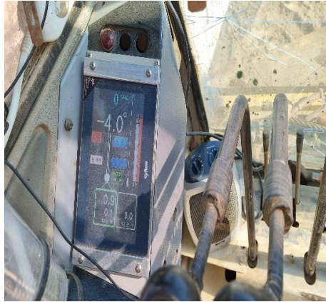
- 운전실 조작 레버 및 인디게이터 과부하장치 점검 상태양호
