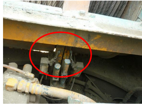
드럼브레이크 및 역회전방지장치 상태 확인 - 상태 이상 무
