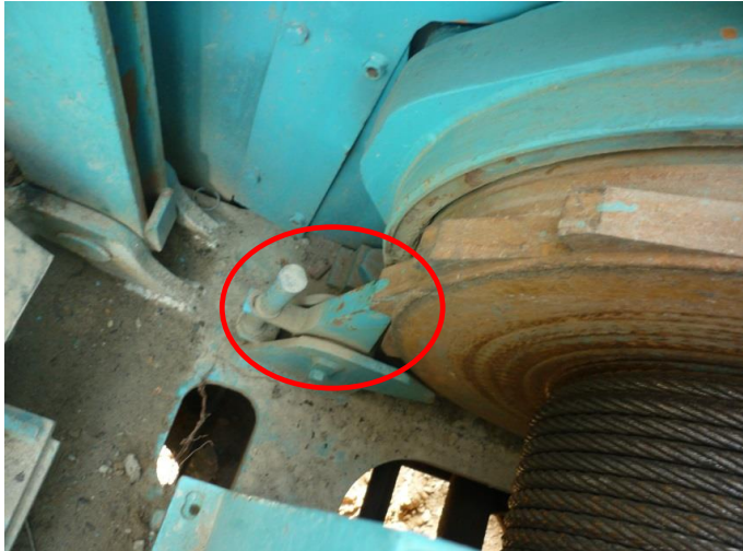
드럼브레이크 및 역회전방지장치 상태 확인 - 상태 이상 무
