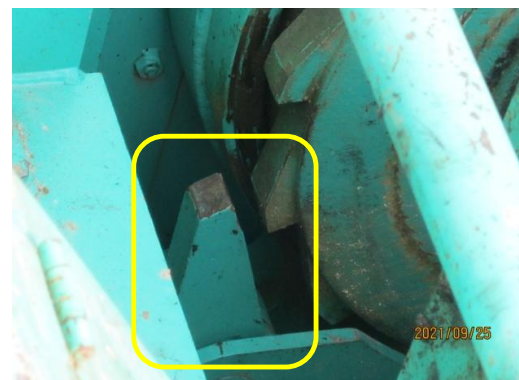
와이어로프상태 및 드럼 역회전방지장치 상태 점검 - 상태 양호
