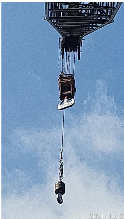
권과방지장치 작동상태 확인 이상무 / 작업상태등 상태 이상 무
